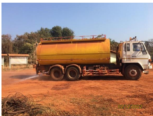
รูปที่ 2-7 รถฉีดพรมน้ำบริเวณเส้นทางขนส่งแร่
